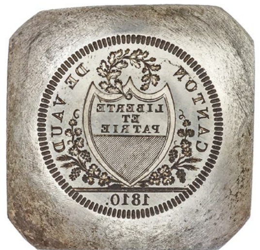
Troquel de anverso y reverso para la acuñación a molino de la pieza de 20 Batzen. Cantón de Vaud, Lausana, 1810.
