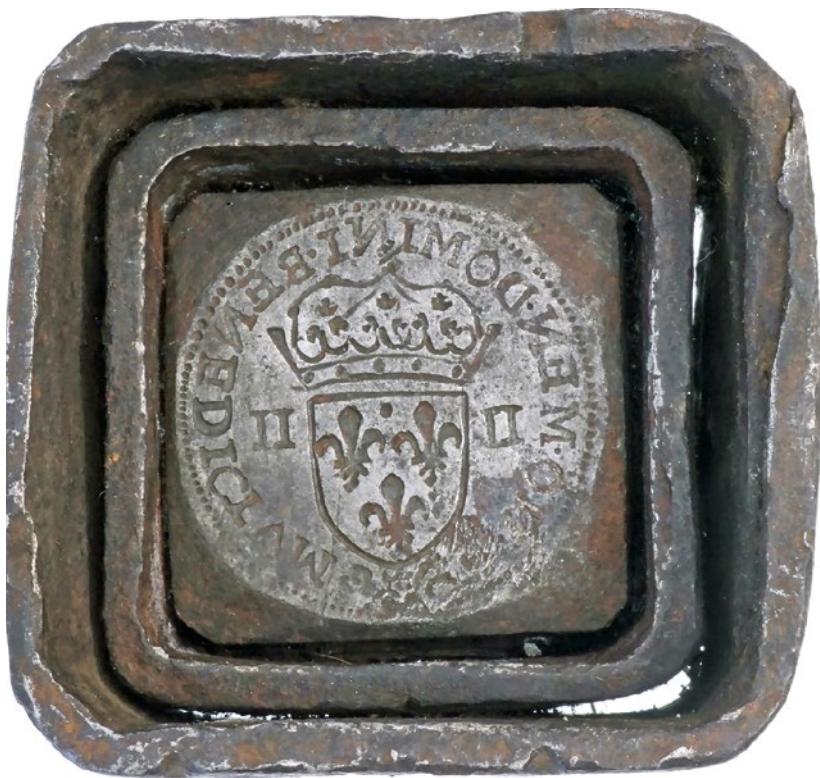
Troquel de hierro móvil para la acuñación a martinete o a molino de ¼ de escudo. Reino de Francia, Enrique IV (1589–1610), taller indeterminado.
